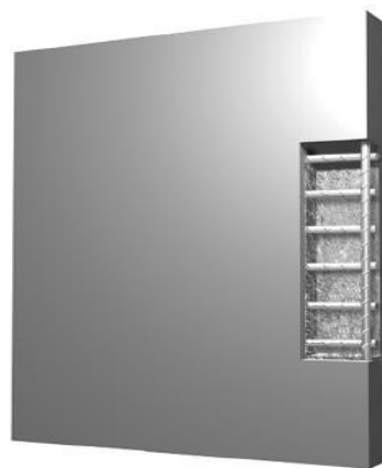
Figura 6 - Vista da peça após tratamento das armaduras
